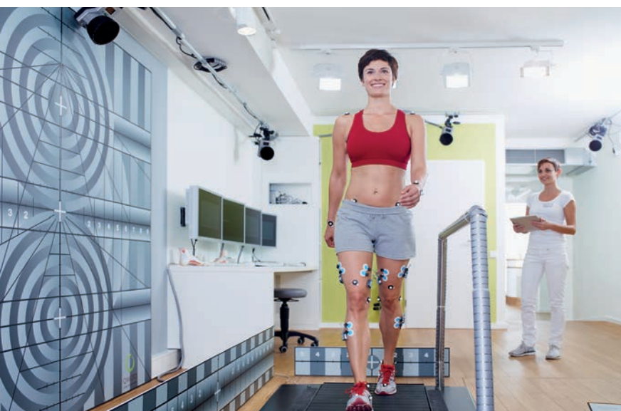
Das QIMOTO Labor setzt das 3D-Motion-Capture-Verfahren ein, um komplexe Bewegungsanalysen zu erstellen
